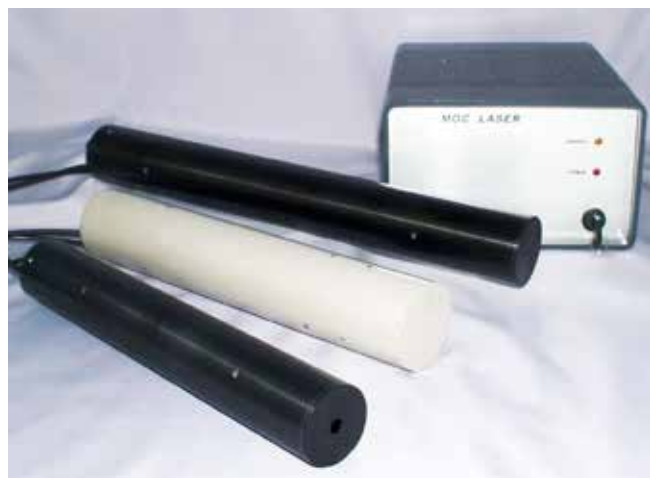
高精度計測用周波数安定化レーザ光源。手前から「QS」、「QQD」、「YS307」
