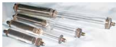
高精度計測用周波数安定化レーザ光源。手前から「QS」、「QQD」、「YS307」
